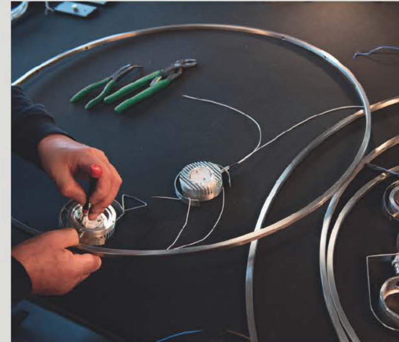
Vorbereitung aller Komponenten zum Umbau auf LED
